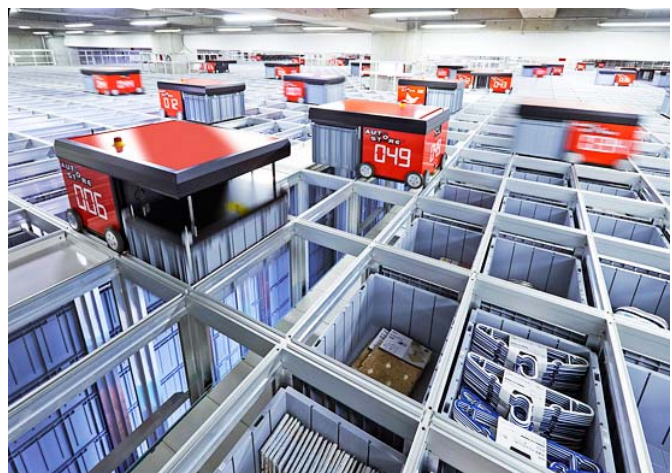
ロボット倉庫システム・オートストア。ロボットがグリッド上を縦横無尽に走行し、商品の入ったコンテナを入出庫する。
